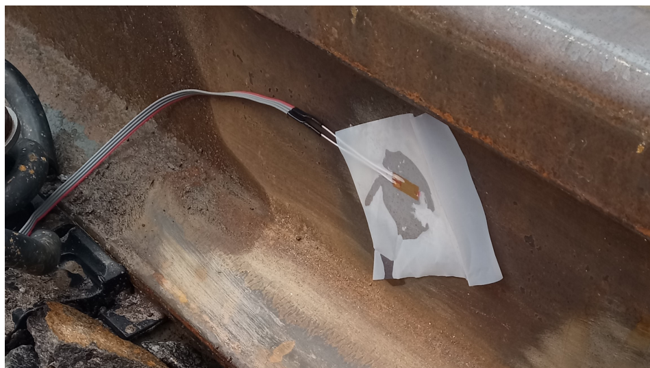
Obrázek 3: Připevnění tenzometru rychlevytvrzujícím lepidlem 1-Z70.
