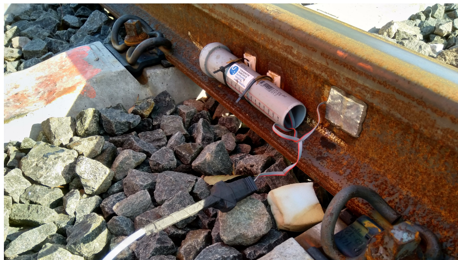
Obrázek 4: Spojení traťové a mobilní části měřicí sestavy během měření.
