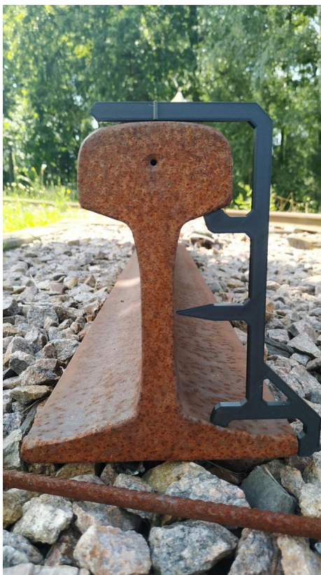
Obrázek 8 – Měrka pro vyhledání neutrální osy kolejnice vytištěná na 3D tiskárně.
