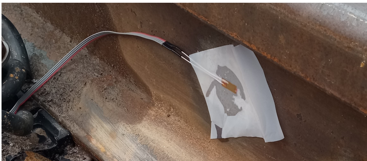
Obrázek 4 – Nalepený tenzometr (ještě s teflonovou příkrývkou) s vyznačenými vodorovnými čárkami.
