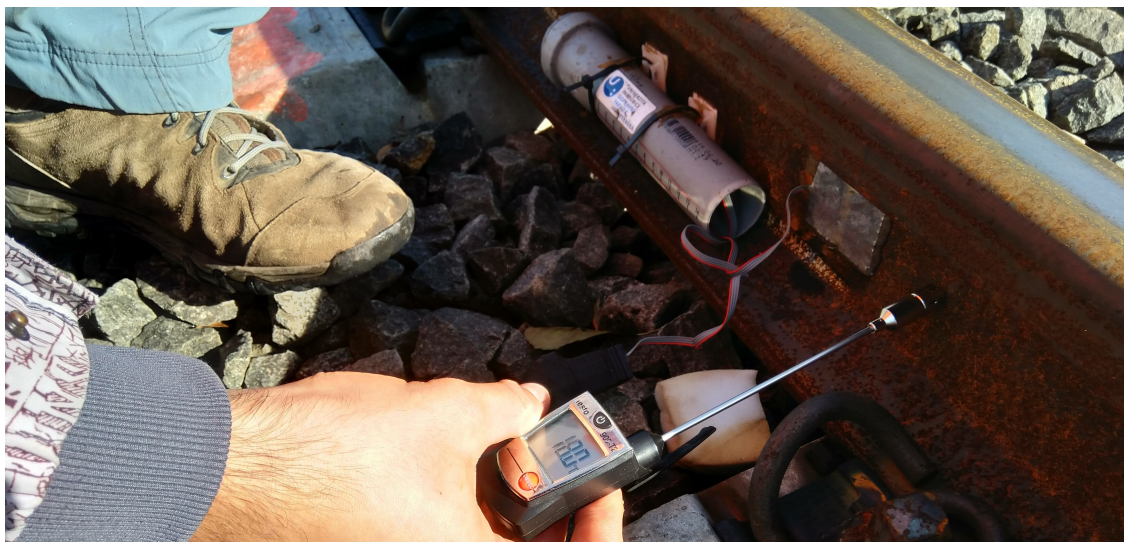
Obrázek 2 – Ukázka měření teploty dotykovým teploměrem za současného připojení traťové a mobilní části měřicí sestavy (v pozadí).
